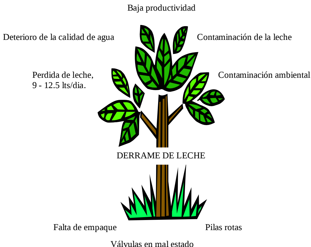
Figura 8. Puntos críticos del derrame de leche encontrados en Productos Lácteos Catacamas (PROLACA), aplicando la técnica del Árbol de Causas y Consecuencias.
