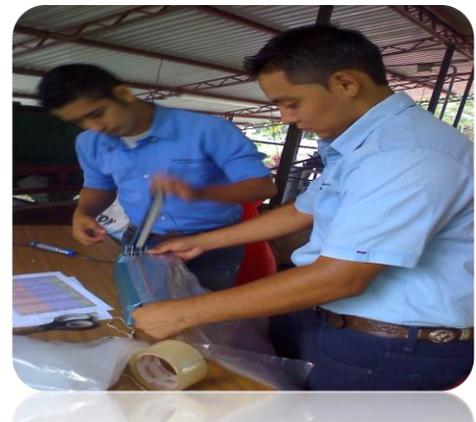
**Anexo 5.** Forma de homogenizar las muestras mediante el cuarteo manual.
