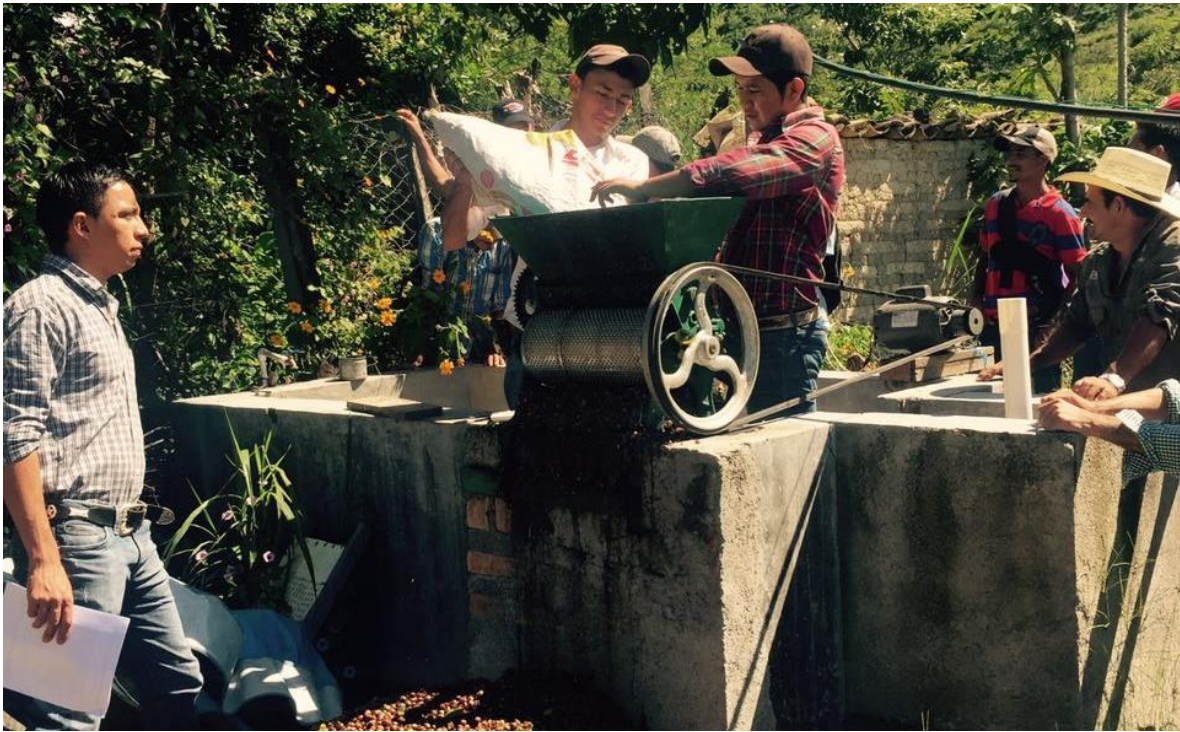
Figura 6. Realizando la muestra de cómo calibrar la despulpadora
