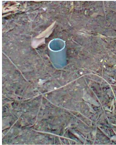
Figura 7. Toma de muestra para la densidad aparente.
